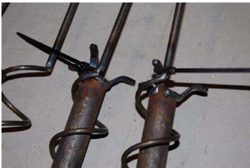
Fig.5 fire turbo-latore placeres som på billedet. Husk at afkorte enderne af strips.
