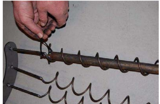
Fig.4 fasthold top af turbo-latorene med strips.
