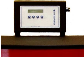
Styringen monteres på bøjljen
